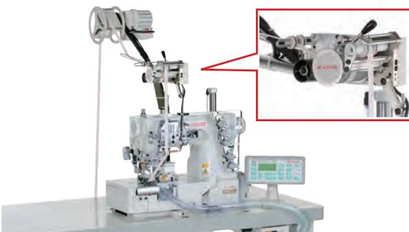
由于通过调节松紧带张力，送出事先设定好的橡筋送出量，因此可以保证平缝折缝线迹均一美观，能对产品的质量稳定与提升作出贡献的装置。
