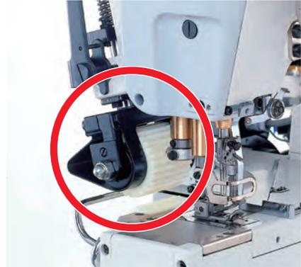
从针落下位置的后方滚筒拉牵布料，所以比较难输送的布料也能顺利的缝纫，实现了没有缝纫错位而美观的缝纫效果。※仅W3600P系列
