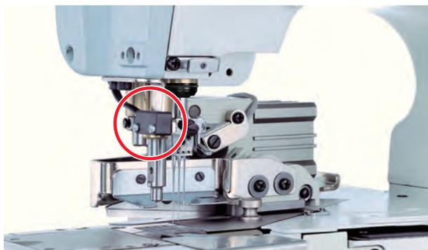
感应器感应到布料边缘后会自动降下剪刀，剪断布条或空线链。根据针数控制可自由调节布条或空线链遗留长度，无论谁来缝纫都可使遗留长度保持一致。
