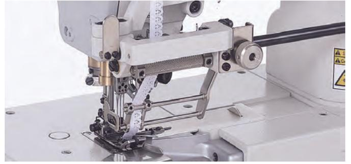
配合布料的输送量送出花边松紧带，即使缝制速度发生变化，相对于布料输送量花边松紧带输送量总是一定的。可以均匀美观的缝纫花边松紧带。
