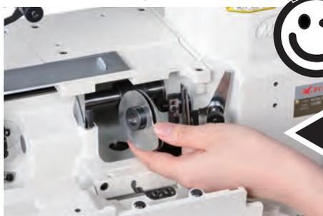
可以在不损坏下线凸轮机构的情况下拆线！
