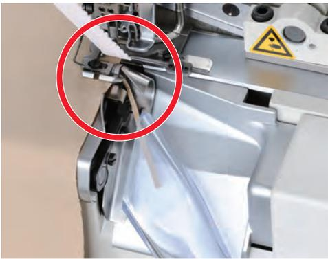
使用绷缝缝纫机进行折缝、缝松紧带、穿松紧带等作业时，修剪布料边的装置。能使布料边没有参差不齐的毛边，因而获得美观的缝纫效果。
