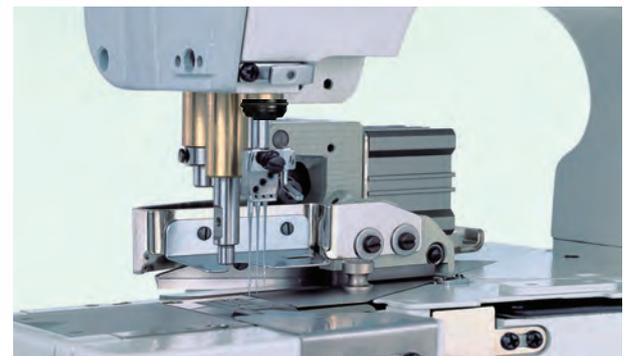
通过开关操作降下剪刀，剪切布条类或空线链，没有必要使用剪刀剪切布条或空线链。开关分手动开关与膝动开关两种。
