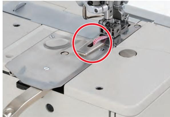
因为在压脚正背面、与针板水平的位置吸入空线环，所以宽边的空线环或双重环的空线环、极粗的线以及毛线都能顺利的吸入。
