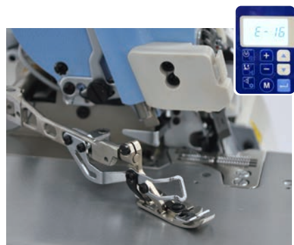
3.带开闭感应的压脚抬升支架
