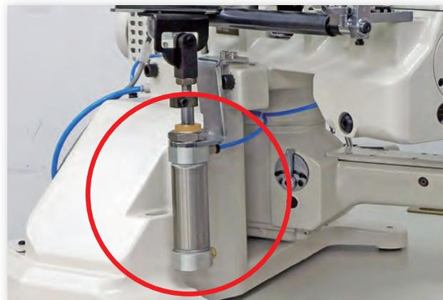
通过脚踏板控制压脚抬起。可以减轻操作工的疲劳，从而提高生产效率。
