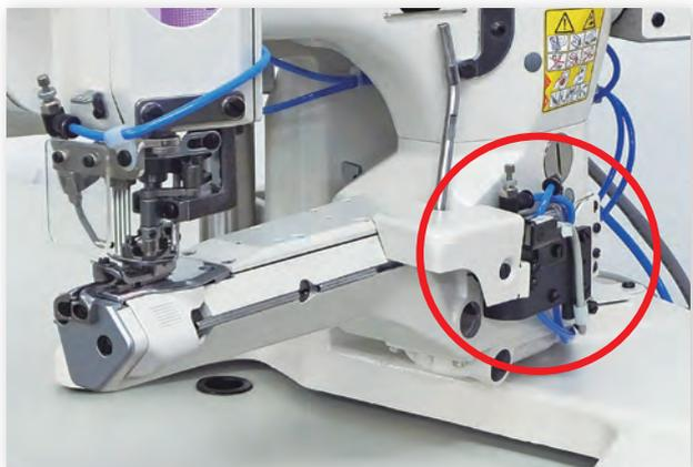
通过脚踏板可以轻松控制剪线，从而大幅提高生产效率。（FW204S系列除外）
