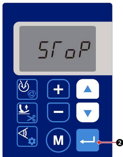
Pour reprendre la couture, appuyer sur
